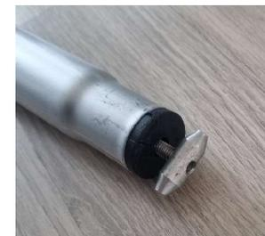
Dies kann mit einem Besenstiel erfolgen, der von der Gegenseite eingesetzt und der alte Einsatz damit herausgedrückt wird.
