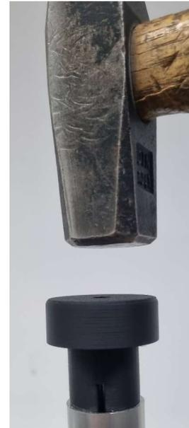
6. Einschlaghülse nach dem Einschlagen auf dem Einsatz belassen und Gewindestift mit Sechskant-Winkelschraubendreher einschrauben.
